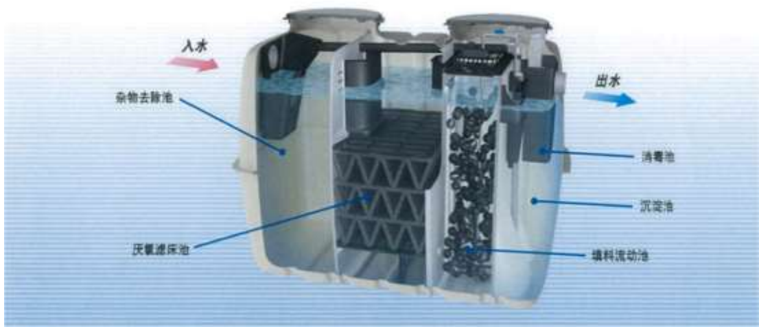
图 4.15-4 净化槽断面图
