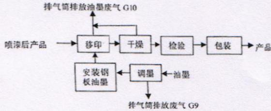
移印工艺流程
