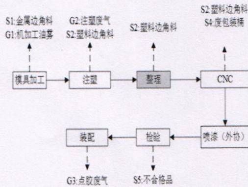
调整后生产工艺流程 (新增注塑件整理工序)
