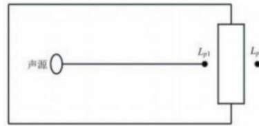
图 4.2.3-1 室内声源等效为室外声源图例
