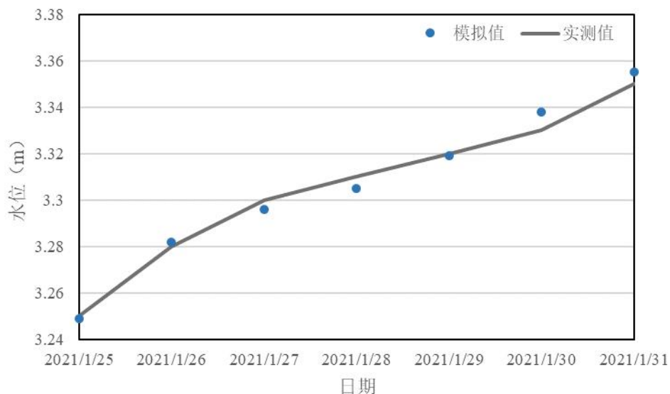
图 5.2-20 河网模型常州（三堡街）点位水位率定结果
