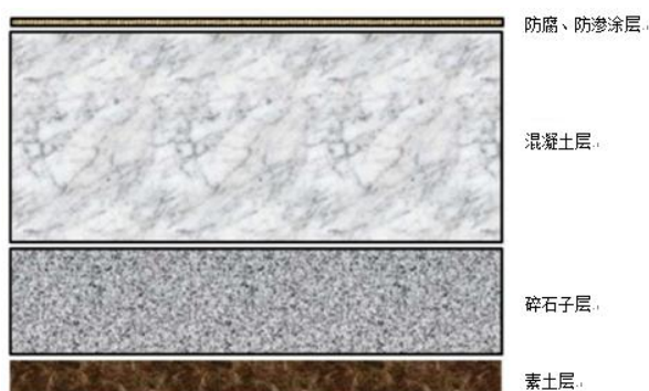
图 4-4 重点区域防渗层剖面图
