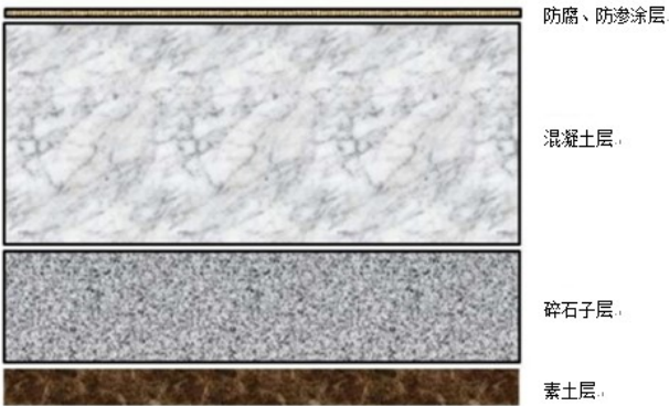
图 4-2 重点区域防渗层剖面图
